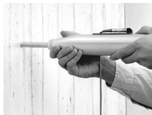
Fig. 5.2 Sortie de la tige de percussion (1)
