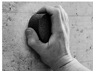
Fig. 5.1 Préparer la surface à tester
