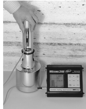
Fig. 6.1 Funktionskontrolle des Betonprüfhammers
