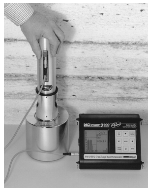
Fig. 6.1 Contrôle du fonctionnement du scléromètre à béton
